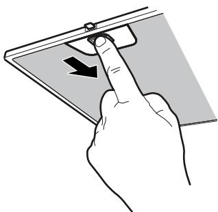
2. Desmontar o filtro metálico de gorduras do dispositivo de fixação.
